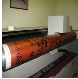
Resim 2.16: İnjecktte desenin şablona aktarılması
