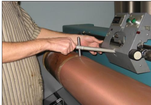
Resim 2.7: Şablon üzerinde aks alma
