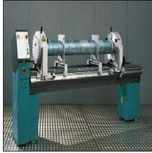
Resim 3.5: Halojen lambalı şablon kafası takma makinesi
