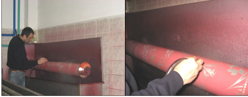
Resim 2.20: Şablonun tazyikli suyla açılması
